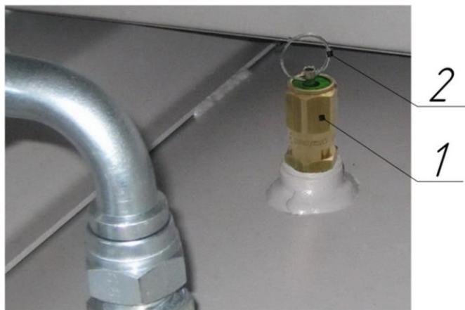
Рисунок 9 – Клапан предохранительный пружинного типа
